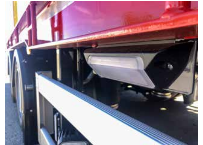
ARPE-Trailer Oy:n valmistamassa monitoimilavetissa huomioidaan työturvallisuus hyvin erillisten sivutyövalojen ja hätäkatkaisimien avulla.
